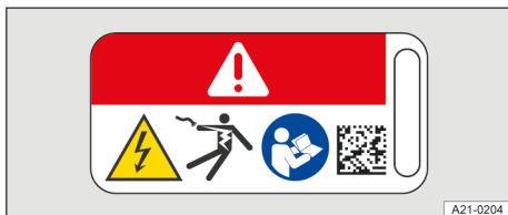
Obr. 5 Varovný štítek na vysokonapětových součástech.
